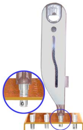
Рисунок 2. Диспенсер – устройство для подачи шарика в микрокувету.
